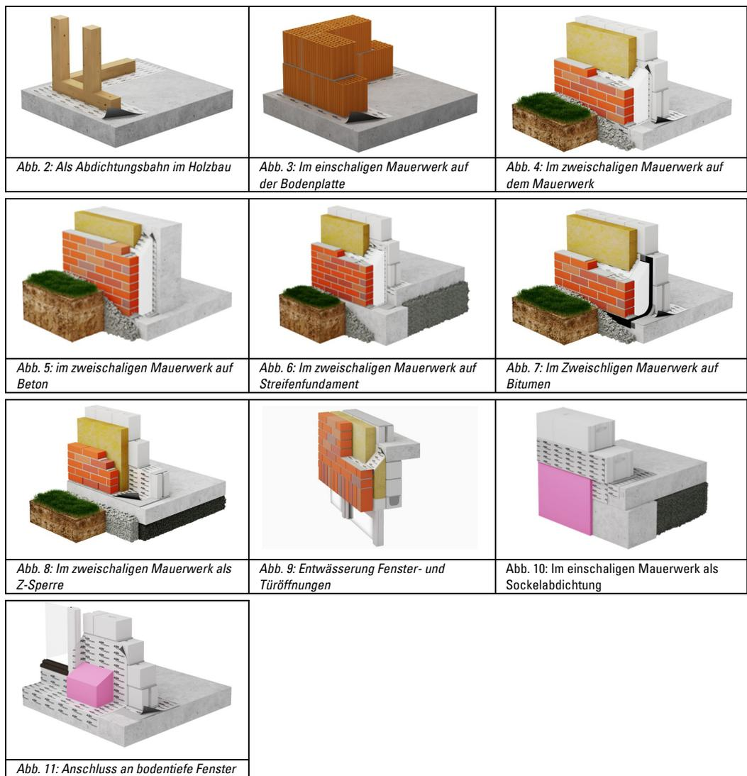
**Systemkomponenten** ► ALUJET Anschlussstreifen Speed; ALUJET Montagekleber WAL; ALUJET Allfixx:
