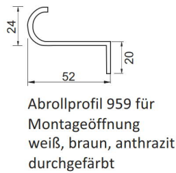
F411 Abrollprofil für Montageöffnung 48 mm
