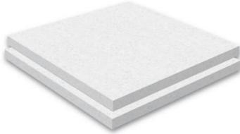
Druckbelastbare Flachdachdämmplatte aus Styropor® (EPS-Hartschaum) gemäß DIN EN 13163 zum Einsatz zur Außendämmung im Flachdach unter Abdichtung. Druckfestigkeit, dh = hohe Druckfestigkeit. Die Kantenausführung ist stumpf, optional mit Stufenfalz zur Vermeidung von Wärmebrücken lieferbar.
