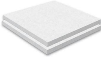
Druckbelastbare Flachdachdämmplatte aus Styropor® (EPS-Hartschaum) gemäß DIN EN 13163 zum Einsatz zur Außendämmung im Flachdach unter Abdichtung. Druckfestigkeit, dm = mittlere Druckfestigkeit. Die Kantenausführung ist stumpf, optional mit Stufenfalz zur Vermeidung von Wärmebrücken lieferbar.
