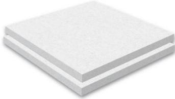
Druckbelastbare Flachdachdämmplatte aus Styropor® (EPS-Hartschaum) gemäß DIN EN 13163 zum Einsatz zur Außendämmung im Flachdach unter Abdichtung. Druckfestigkeit, ds = sehr hohe Druckfestigkeit. Die Kantenausführung ist stumpf, optional mit Stufenfalz zur Vermeidung von Wärmebrücken lieferbar.
