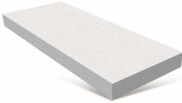
Druckbelastbare Bodendämmplatte aus Styropor® (EPS-Hartschaum) gemäß DIN EN 13163 zum Einsatz zur Dämmung im Fußboden unter Estrich, ohne Trittschallanforderung. Druckfestigkeit, dh = hohe Druckfestigkeit. Die Kantenausführung ist stumpf, optional mit Stufenfalz zur Vermeidung von Wärmebrücken lieferbar.
