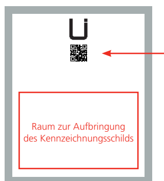
Bild 1: Innenseite des Mantelsteinverschlusses der unteren Putztüre
