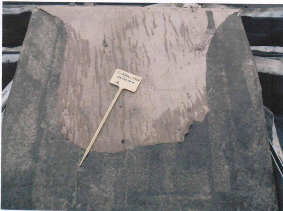
Abb. 2: Abdichtungsunterseite ohne Durchwurzlungen.
