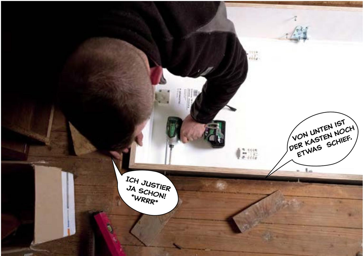
**SCHRITT 5: Scharniere am Deckel befestigen**
