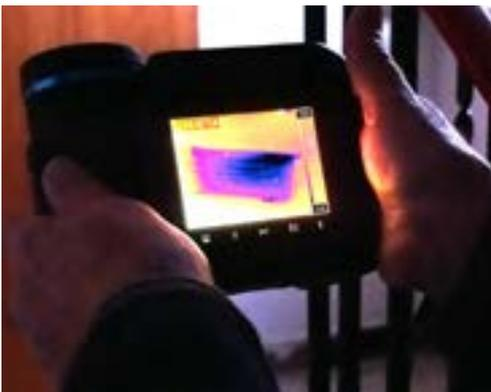
Das idealtypische Bild einer top-gedämmten Bodentreppe. Hier ist der kalte Bereich minimal ausgeprägt.
