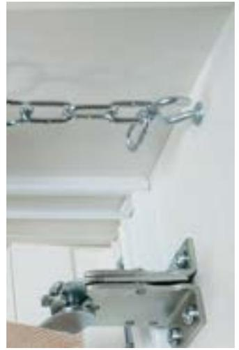
Kette mit Federverbinden und am Haken im Lukenkasten einhängen. Für mehr oder weniger Zugkraft der Feder einfach die Kette ein Glied weiter einhängen.
