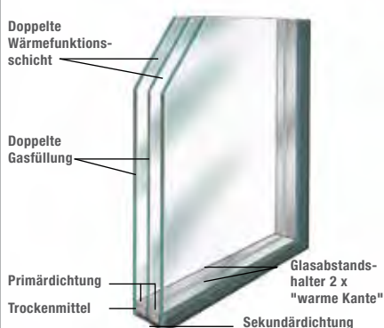
Wärmeschutzglas U g 0,6 mit 2 x Randverbund "warme Kante"
