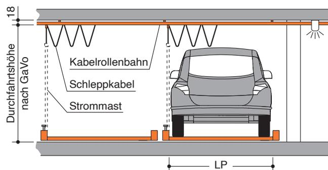
**!** Zwischen vorderen bzw. hinteren Stoßstangen von Fahrzeugen auf ParkBoards zu festen Teilen der Umgebung oder anderen Fahrzeugen muss gemäß DIN EN 14 010 ein Sicherheitsabstand von 30 cm eingehalten werden. Bei einer max. Fahrzeuglänge von 500 cm ergibt sich dadurch ein Längenmaß von 560 cm zwischen den Stützen. Das Längenmaß von 560 cm kann nur dann verkürzt werden, wenn die max. Fahrzeug- bzw. Stellplatzlänge reduziert wird oder Lichtschranken eingesetzt werden.
