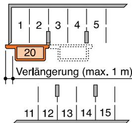
Bei Verwendung des **Antriebs D** ist keine einseitige ParkBoard-Verlängerungen notwendig. Der **Antrieb D** erlaubt einen längeren Verfahrweg.
