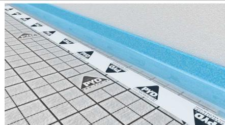
**Achtung:** Wird Calciumsulfatestrich eingesetzt, muss der Foliensflansch des Randdämmstreifens spannungsfrei und vollständig mit der Systemplatte verklebt werden. Der PYD®-RDFK Randdämmstreifen ist dafür werkseitig mit einem Klebestreifen ausgestattet.
