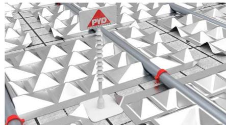
Die PYD®-EM Estrichmesstellen werden mit genug Abstand zu den Systemrohren mittig einmal pro Raum gesetzt. In größeren Räumen >50m² entsprechend mehr.
