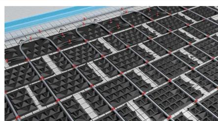
**Achtung:** Bei Verwendung von Blechen mit schwarzer Beschichtung und Fließestrich müssen bei Verlegung der Systemart VV nach jedem Blech PYD-Systemclips gesetzt werden. Andernfalls muss maximal alle 50 cm ein Clip gesetzt werden.
