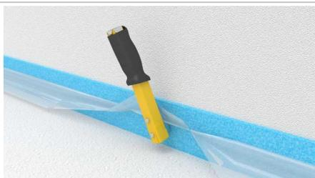
Die Befestigung des PYD®-Randdämmstreifens sollte im Bereich der Trittschalldämmung erfolgen um Schallübertragungen zu vermeiden.
