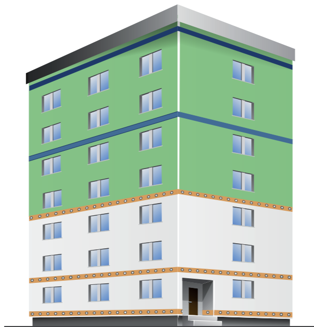
Brandriegel verhindern den Brandüberschlag über die Fassade.
