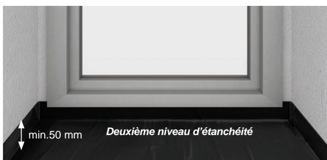
Ill. 4 : Représentation schématique du second niveau d'étanchéité en forme de cuvette
