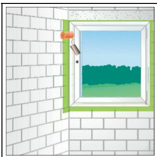
5. Bild: Folie mit einem Andruckroller anrollen
