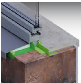
Lösungsmöglichkeit: Innen: ME500 TwinAktiv EW mit SP025 Fensterfolienkleber Öko, Mitte: FM220 PUR-Schaum Basic
