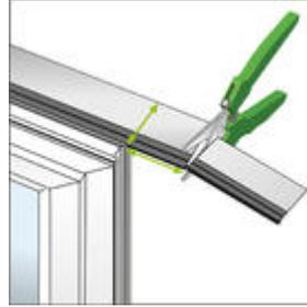
Bild 15: Folie im Eckbereich mit einem Breitenüberstand abschneiden
