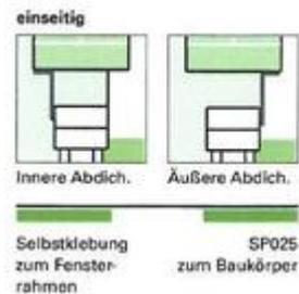
E = einseitig: ein Selbstklebestreifen befindet sich auf der glatten, unbedruckten und dämmstoffseitigen Folienseite.
