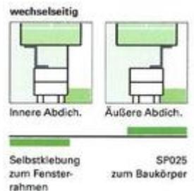
W = wechselseitig - ein Selbstklebestreifen zum Fensterrahmen befindet sich auf der überputzbaren, bedruckten und sichtbaren Folienseite.
