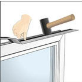
Bild 14: Geeignete Kederfolie in die äußeren Blendrahmen-Nuten einbringen
