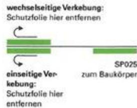
EW+ / EW = einseitig und wechselseitig: Selbstklebung kann sowohl wechselseitig als auch einseitig genutzt werden, je nachdem, auf welcher Seite die Abdeckung der Selbstklebung entfernt wird.
